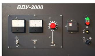
Выпрямитель ВДУ-2000 предназначен для комплектации сварочных автоматов. В комплекте со сварочным автоматом предназначены для сварки и наплавки под слоем флюса на постоянном токе.
