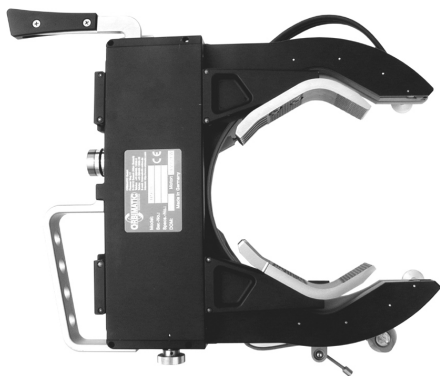
Зажимной механизм и зажимы двигаются параллельно относительно друг друга
