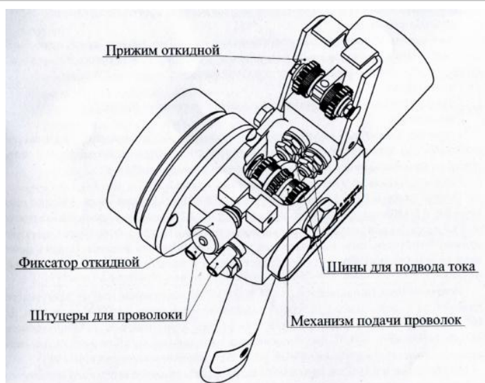
Внешний вид механизма подачи электрометаллизатора ЭМ-01
