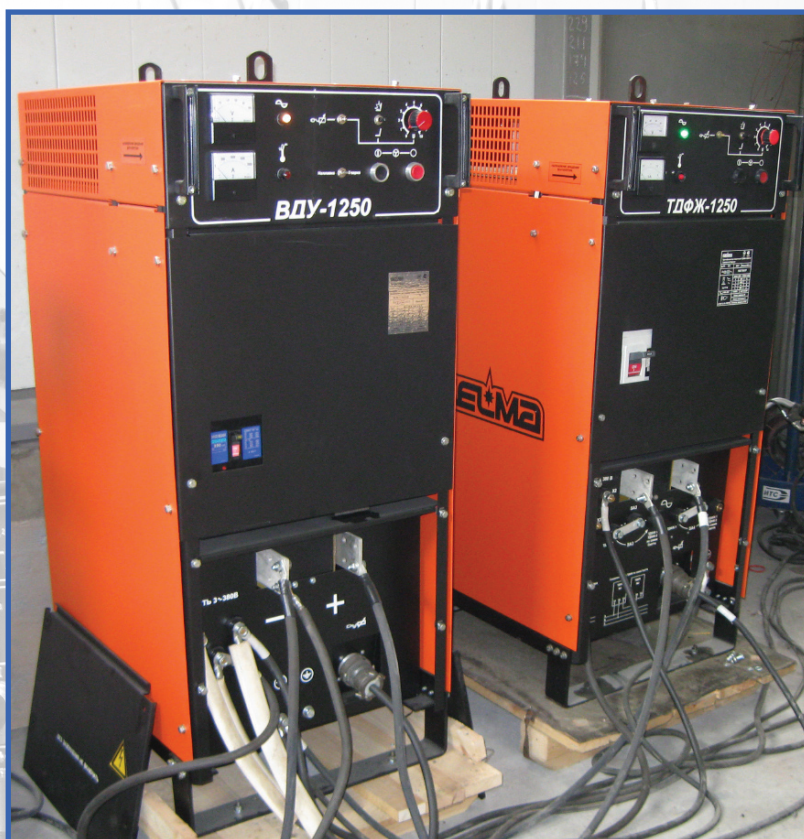
Рис.2 Источники сварочной головки АДФ-2500 (Тандем)
