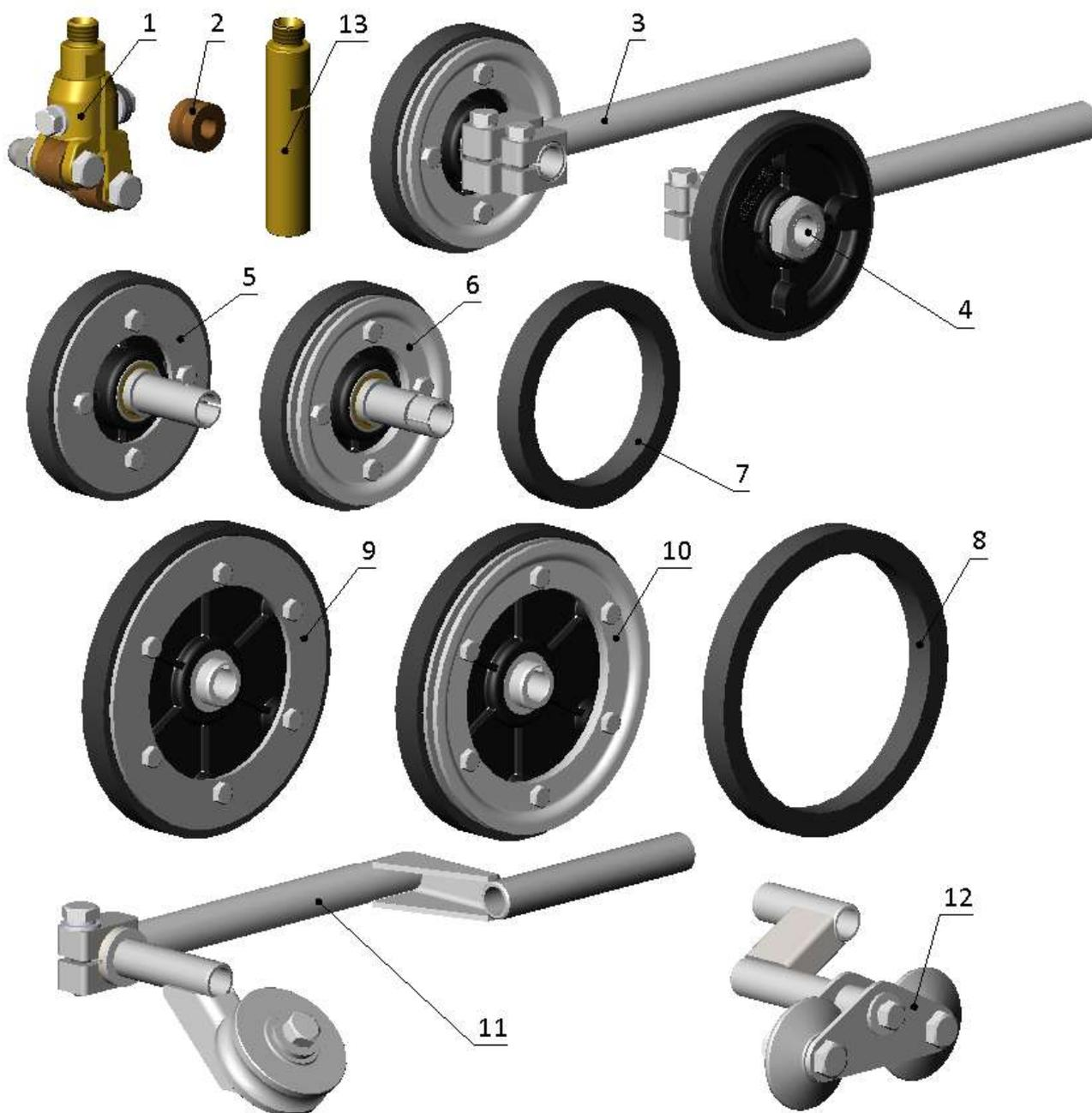
Рис.12. Детали и сборочные единицы трактора сварочного ТСФ-101,
