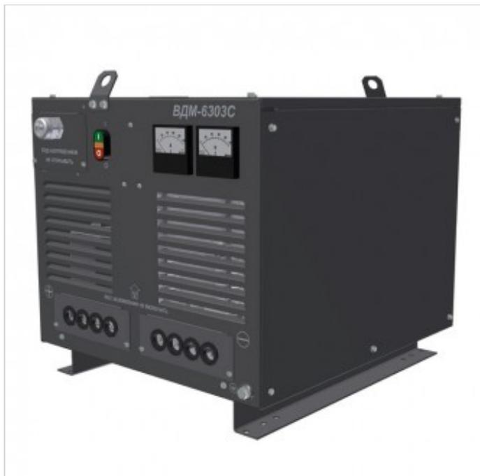
Выпрямитель сварочный многопостовой типа ВДМ-6303С предназначен для комплектации постов ручной дуговой сварки покрытыми электродами изделий из углеродистых и легированных сталей на постоянном токе. Выпрямитель может применяться в стационарных условиях в комплекте с балластными реостатами типа РБ – 302, РБ-306. Выпрямитель не регулируется и имеет жесткую внешнюю характеристику.
