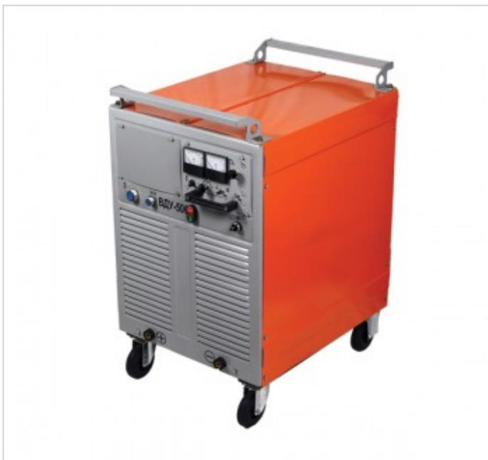
Универсальный выпрямитель ВДУ-506 предназначен для комплектации полуавтоматов, обеспечивающих сварку малоуглеродистых и низколегированных сталей в защитных газах на постоянном токе. Также ВДУ-506 используется в качестве источников для автоматической сварки и ручной дуговой сварки на постоянном токе.
