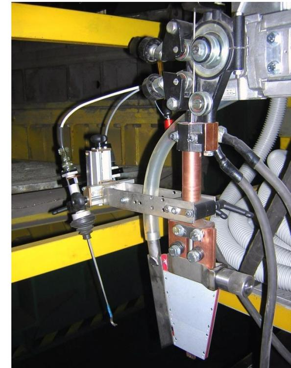
Комплекс позволяет производить автоматическую сварку под флюсом сферических и эллиптических днищ, собранных из отдельных «лепестков» меридиональными швами.
