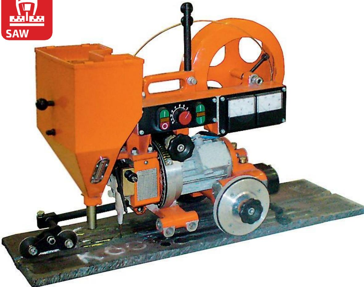
**Сварочный трактор ТС-16 в комплекте с источником сварочного тока предназначен для автоматической сварки под слоем флюса различных типов соединений (стыковых, нахлесточных, угловых, «в лодочку») с разделкой и без разделки кромок прямым и наклонным электродом. Для выполнения прямолинейных швов. В процессе работы трактор передвигается по изделию или по уложенной на него линейке.**
